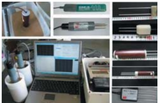
塩濃度の影響が少ない土壌水分計を開発するための基礎的な実験
