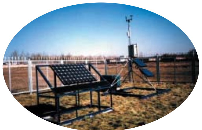
砂漠環境での太陽光発電の実証試験
