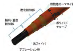
大気圏突入機用飛行アブレーションセンサー
