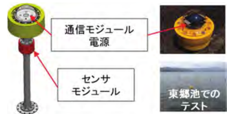
湖沼水モニタリングシステム概要
