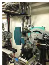
SPring-8でのX線応力測定その場引張試験
