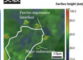
超高強度鋼に対するナノ硬さ測定とその数値シミュレーション
