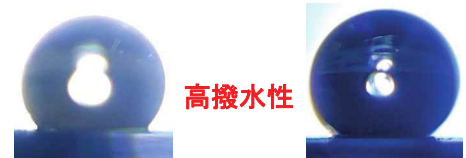
超分子集合体のSEM観察像および各構造体が示した撥水性の写真
