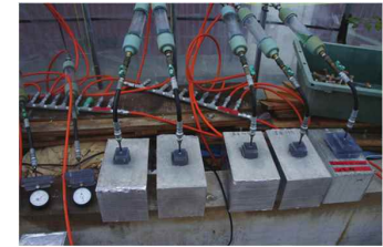
鋼材腐食の防止を目的としたコンクリート内部への亜硝酸リチウム水溶液の圧入工法の開発
