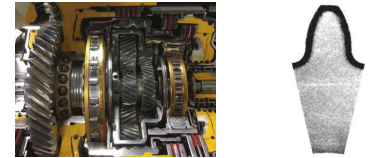
自動車用トランスミッション 焼入れによる歯型の硬化層
