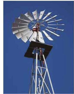
メキシコで揚水ポンプの駆動に使用されている多翼型風車
