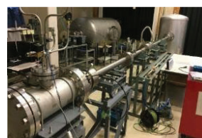
超高速大気圏突入試験用自由ピストン衝撃波管
