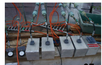
ASRに配慮した電気防食工法の開発
