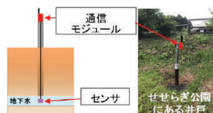
地下水モニタリングシステム概要
