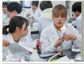
細胞が細菌などによって汚染されないために、ガスバーナーで無菌空間を作っているよ! 細胞培養においてとても重要な工程なんだって!
