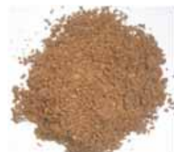
鳥取県で廃棄された廃瓦より製造した砂
