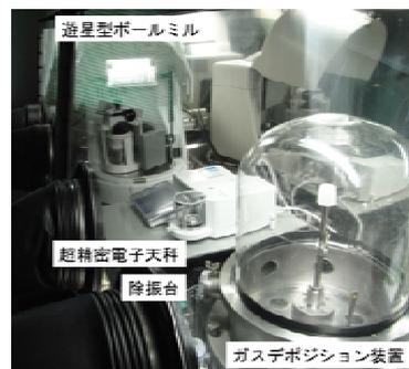
【図5】材料合成から電極作製までの一連の工程を不活性ガス雰囲気中で行えるシステム(グローブボックスの内部を撮影)
