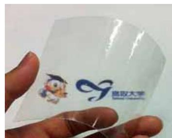
【図2】キチンナノファイバーを配合したプラスチックフィルム
