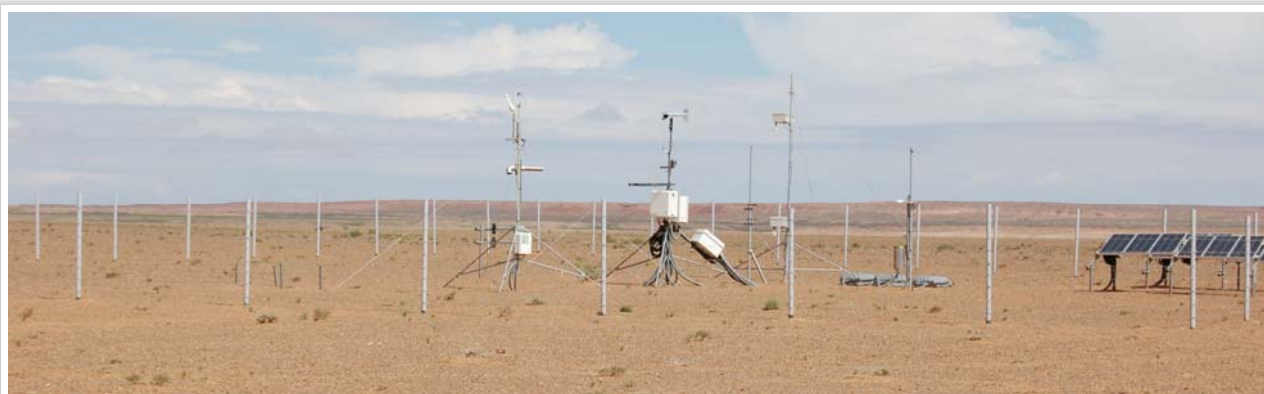
【図1】モンゴルのゴビ砂漠に位置するツォクトオボーに設置した黄砂観測システム
