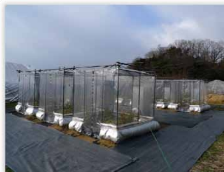
農学部圃場に設置されたCO 2 濃度制御装置 （上部が開いた小型のビニールハウスで、CO 2 濃度を制御した空気を下部から吹き込み栽培実験を行います。）
