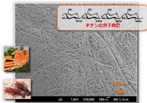
幅10-20nmのキチンナノファイバー（髪の毛の1/10,000） カニ殻由来の新繊維「キチンナノファイバー」
