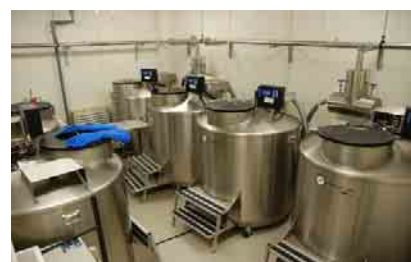
菌株を保存する液体窒素気相タンクと凍結チューブ
