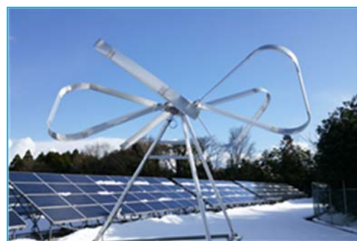
過回転抑制機構によって翼が傾斜した状態
