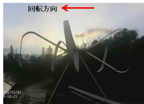
(図B) 発電実験中、強風によってOCSが作動し翼が傾斜して回転数が減少したときの画像
