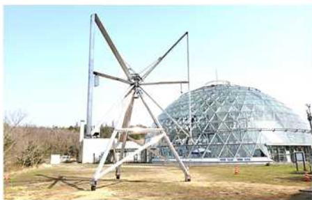
可動アーム式過回転抑制機構を備えた7mバタフライ風車（乾燥地研究センター・アリドーム北側に設置）
