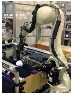
図1 物体を正しくピックする Team T2 のロボットアーム
