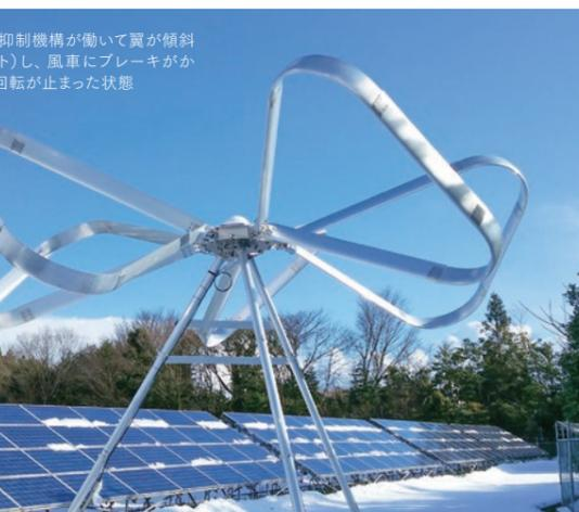
図6 過回転抑制機構が働いて翼が傾斜(ツイスト)し、風車にブレイキがかかって回転が止まった状態
