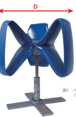
図1 バタフライ風車の風洞実験機
