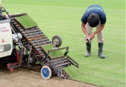
写真1 収穫機1号機の拾い上げ機構
