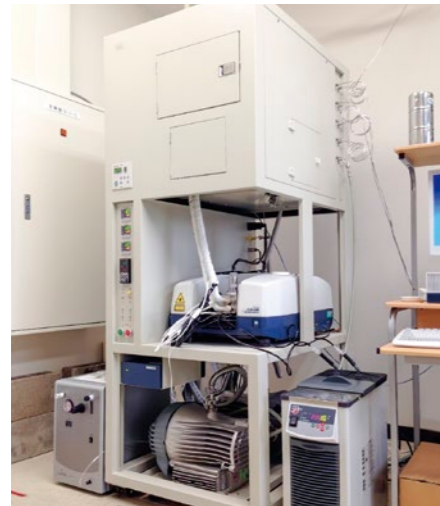
写真2 私たちが開発した固体上での反応解析装置
