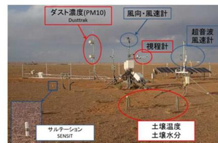
ゴビ砂漠（モンゴル・ツォクトオボー）に設置した黄砂モニタリングステーション。
