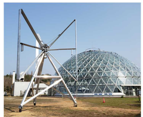
直径7mのバタフライ風車の試作機
