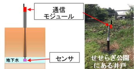
地下水モニタリングシステム概要
