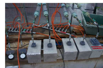
鋼材腐食の防止を目的としたコンクリート内部への亜硝酸リチウム水溶液の圧入工法の開発
