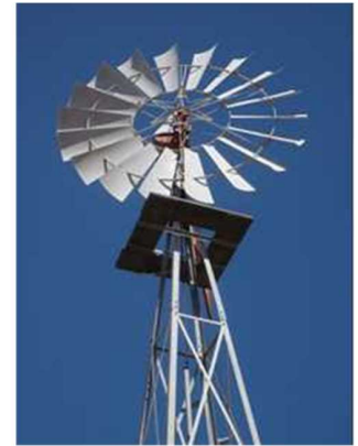
メキシコで揚水ポンプの駆動に使用されている多翼型風車
