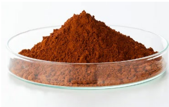
図1. 戸田工業が独自に開発した酸化鉄（ナトリウムフェライト： \text{NaFeO}_2 ）の写真
