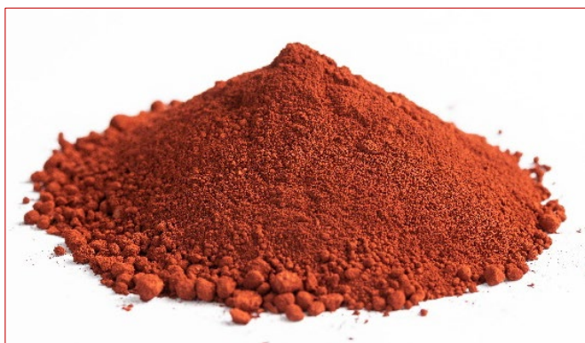
図1. 戸田工業が製造する酸化鉄（ \alpha\text{-Fe}_2\text{O}_3 ：ヘマタイト）。本研究では、戸田工業の独自技術により超微細化した \text{Fe}_2\text{O}_3 粒子をナトリウムイオン電池の負極材料に適用した。
